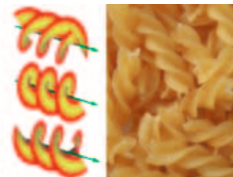
Рис. 18. Витой фронт волны с ненулевым орбитальным моментом напоминает пасту фузилли
