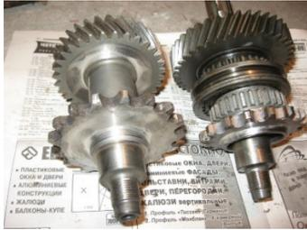
*Abb. 17. Bauteile des Geräts zur Reversierung*
